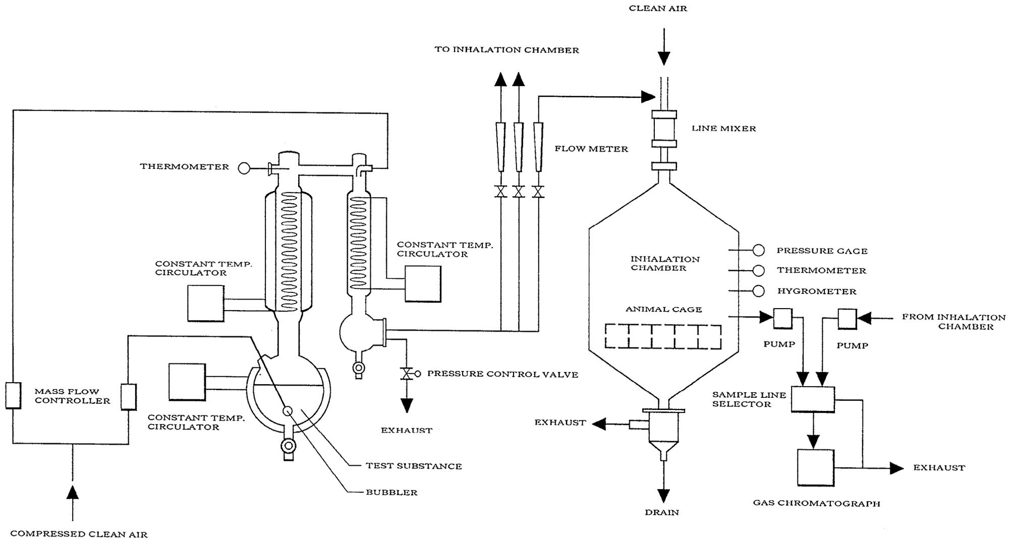
FIGURE 1 DICHLOROMETANE VAPOR GENERATION SYSTEM AND INHALATION SYSTEM
